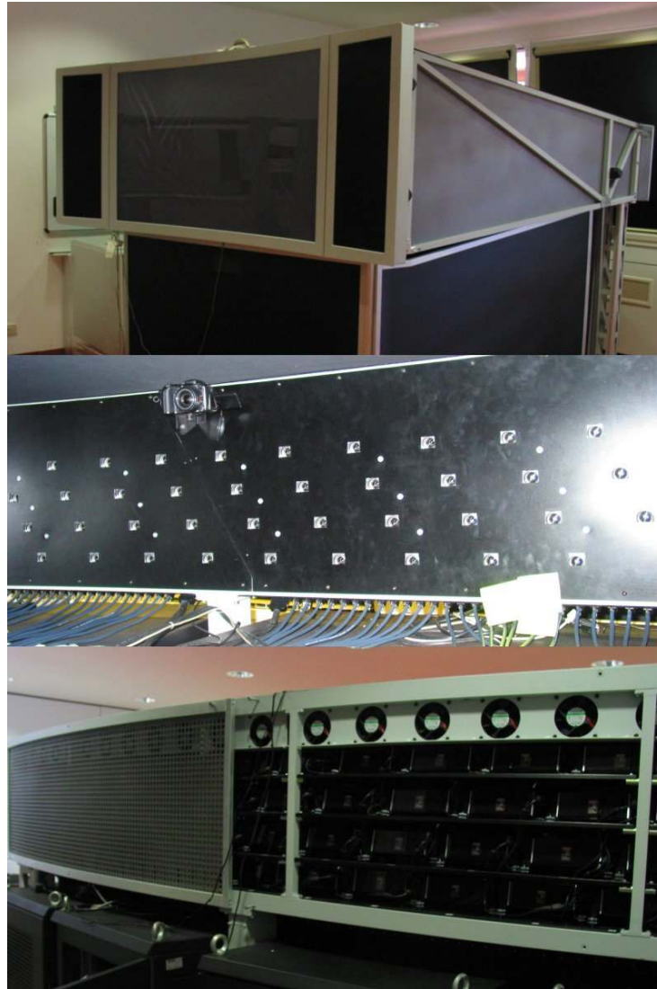
Figura 1.12: Prototipo di light field display di grosse dimensioni. Dalle fotografie si possono apprezzare i dettagli dell'array dei proiettori e della fotocamera utilizzata per la calibrazione situati nella parte posteriore del setup.
