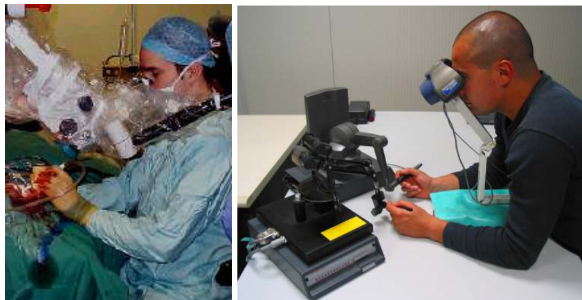
Figura 1.5: Un sistema prototipale per la simulazione di procedure chirurgiche sull’osso temporale. Sinistra: set-up operativo reale, il chirurgo in contatto con il campo operativo solo attraverso gli strumenti. Destra: interfacce aptiche e visive del simulatore [7].
