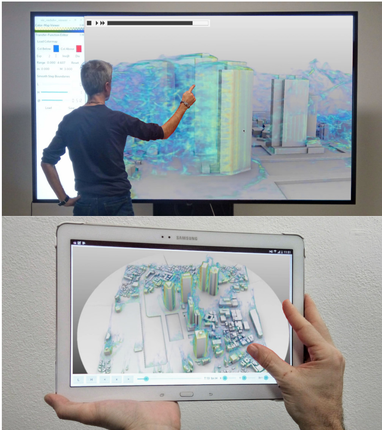
Figura 3.2: Fat client e thin client. Il nostro framework flessibile supporta l'esplorazione spazio-temporale completamente interattiva di simulazioni con migliaia di frame di miliardi di voxel. In alto: fat client che esegue il rendering locale su un touch screen 1920x1080 pilotato da un singolo PC grafico con NVIDIA GTX 1080Ti. In basso: thin client su tablet Android Samsung Galaxy Note Pro SM-P905.
