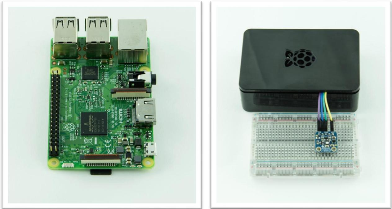
Scheda Raspberry Pi 3 con microSD visibile sul lato inferiore (foto a sinistra) - Edge Gateway con sensore HTU21D (foto a destra)
