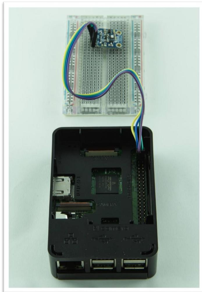
Edge Gateway (Raspberry Pi 3) in test con sensore HTU21D
